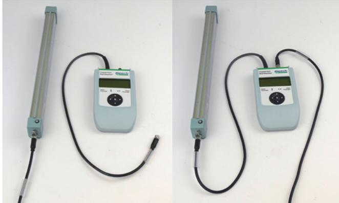
**警告：**在断开静电消除棒电源线之前，建议关闭静电消除棒的 24V 电源并等待几秒钟。虽不至于损害设备，但可能因静电消除棒中的储存能量而产生轻微的电击。
