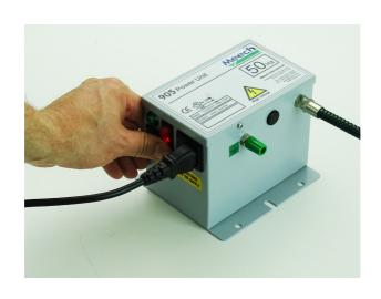
2. 断开连接电源的所有电离装置。
